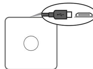
1. Enchufe un extremo del cable micro-USB suministrado en la almohadilla de carga inalámbrica. Enchufe el otro extremo en un cargador USB o en otra fuente de alimentación USB.
