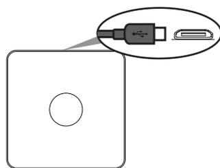
1. Brancher une extrémité du câble micro-USB fourni dans la plaque de charge sans fil. Brancher l'autre extrémité dans un chargeur USB ou sur une autre source d'alimentation USB.
